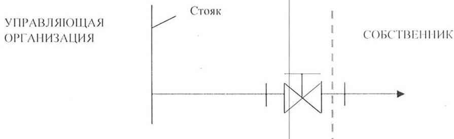
2. По системе водоотведения: точка присоединения трубы системы водоотведения квартиры к стояку общедомовой системы ( первый раструб фасонного изделия ( тройник, крестовина, отвод) на стояке водоотведения) - Постановление Правительства РФ от 13.08.2006 N 491 п.5 .
