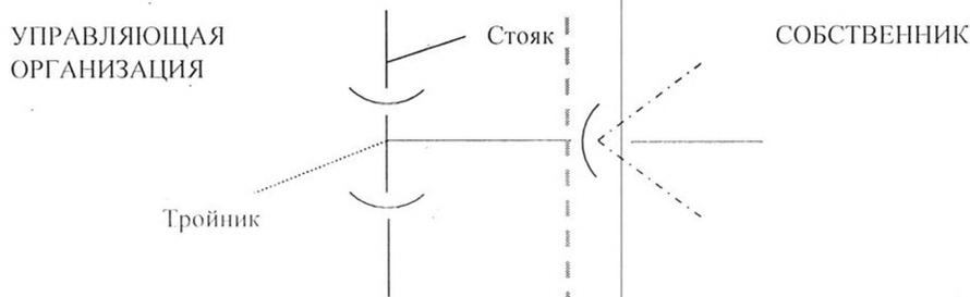
3. По системе теплоснабжения ( отопление ): до вентиля на подводках трубопровода отопления ( подающий и обратный трубопровод) к квартирному радиатору. Если таковые отсутствуют, то граница проходит по резьбовому соединению в радиаторной пробке. При наличии перемычки между подающим и обратным трубопроводом граница проходит по перемычке (Постановление Правительства РФ от 13.08.2006 N 491 ).
