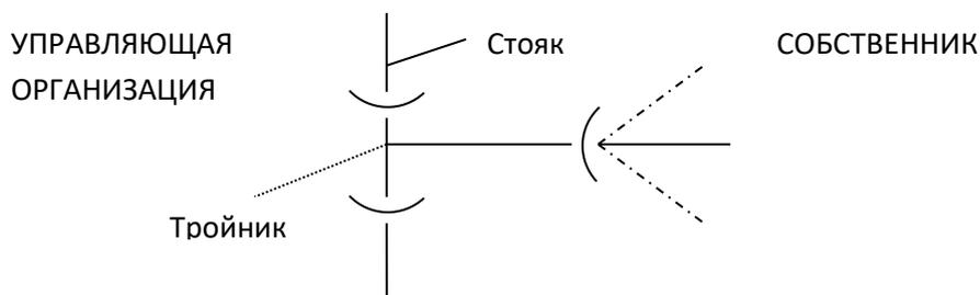
3. По системе теплоснабжения: подводящие и отводящие трубы системы теплоснабжения Управляющая организация, радиатор отопления – Собственник. **А перемычка**
